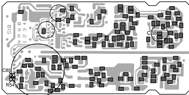
Onderzijde Synthesizer print (SMD)
