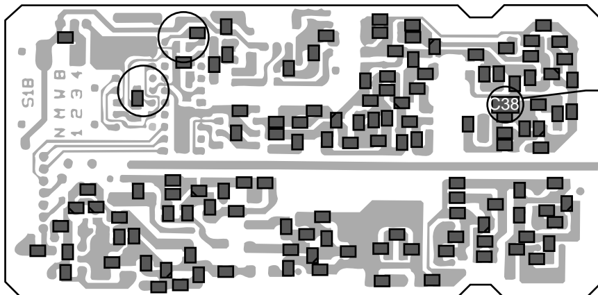
Onderzijde Synthesizer print (SMD)
